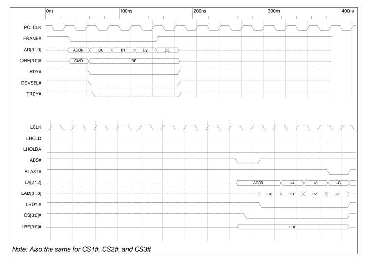
Timing Diagram 8-7. Chip Select 0 (CS0#)
